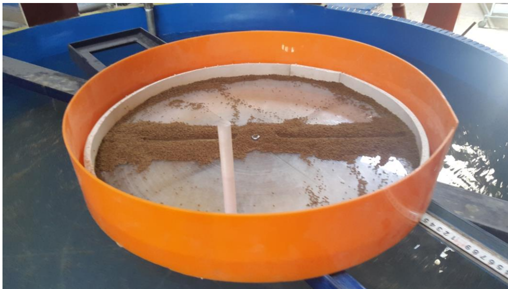
شکل ۳: وسیله توزیع رسوب در مخزن استوانه‌ای
