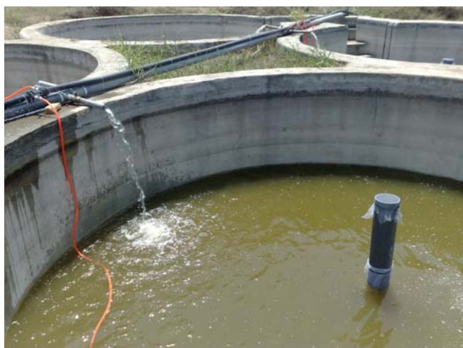
شکل ۲-۲. استخر مدور بتنی با بستر ماسه‌ای بعنوان واحد آزمایشی
