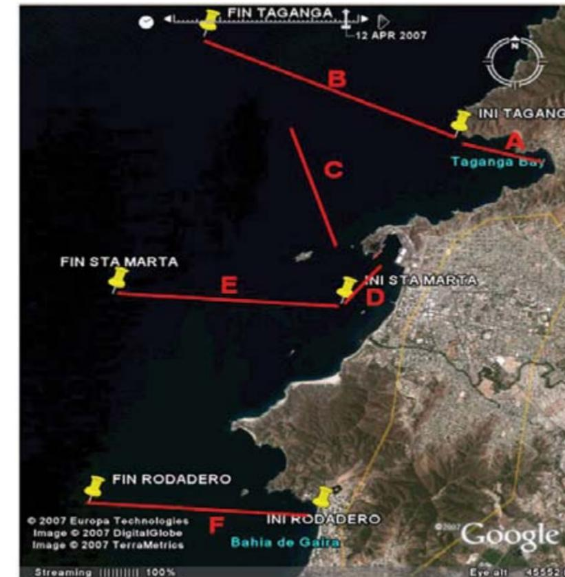
**Figura 4.** Localización de los perfiles levantados con la ecosonda Stratabox™ de 10 KHz. El segmento A (1,63 km) dentro de la bahía de Taganga y el B (4,65 km) como prolongación hacia el mar del anterior. El C (2,67 km) es un perfil meridional en la boca de la bahía de Taganga. El perfil D (1,35 km) es de calibración dentro de la Bahía de Santa Marta. El perfil E (4,25 km) frente a la ciudad de Santa Marta y el perfil F (4,5 km) frente a la playa de El Rodadero.
