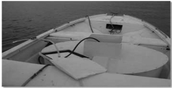
Fig. 2. Ejemplo de tanque utilizado para el transporte marino.
