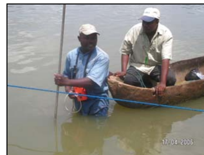
Jaugeage de vitesse au Moulinet
