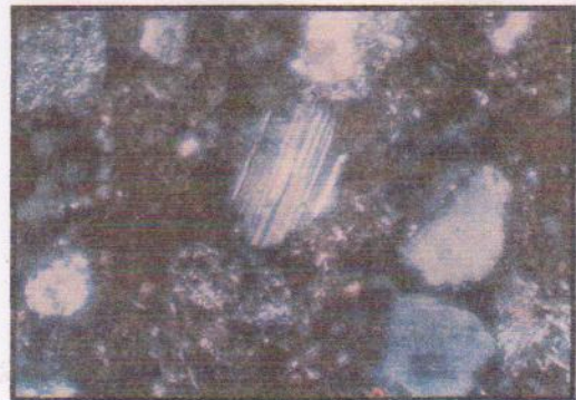
Fotografía 6. Feldespato del tipo Labradorita. Mineral típico de rocas ígneas básicas. Aumento 100x. Nícoles cruzados.
