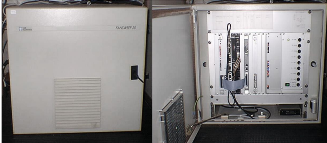
Figura 5. Ecosonda interferométrica Atlas Fansweep 20 de la DIHIDRONAV.
