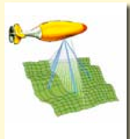
Esquema de operación de un vehículo operado remotamente (AUV) efectuando batimetría multihaz.
