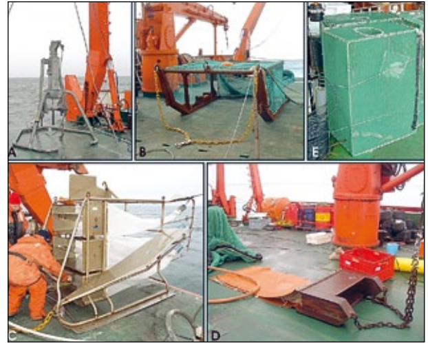
Figura 2. Artes de muestreo utilizados en las campañas BENTART. A, box-corer. B, draga Agassiz. C, trineo suprabentónico. D, draga de roca. E, línea de nasa.
