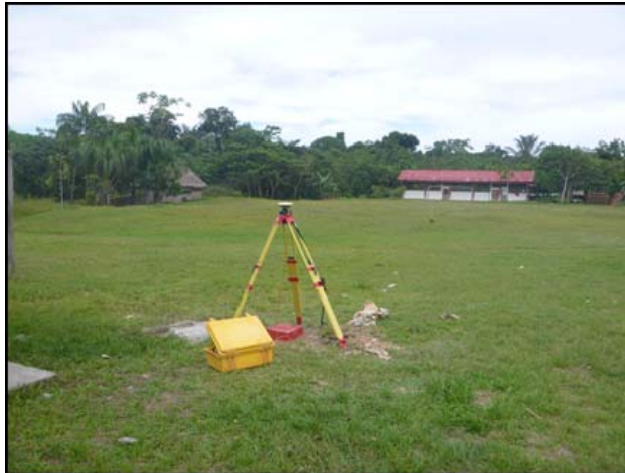
Figura 9: Ejemplo sobre el posicionamiento geodésico de un hito determinado en el caserío Villa Belén – Iquitos. Imagen tomada del Informe Técnico sobre el Levantamiento del río Itaya – DHN.
