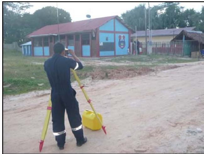
Figura 10: Ejemplo de una nivelación diferencial. Imagen tomada del Informe Técnico sobre el Levantamiento del río Itaya – DHN.
