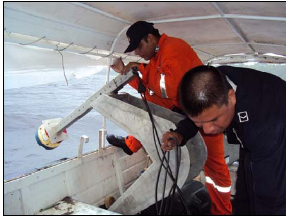
Figura 12: Ejemplo de una medición de caudal en el río Amazonas – Iquitos. Imagen tomada del Informe Técnico sobre el Levantamiento del río Itaya – DHN.
