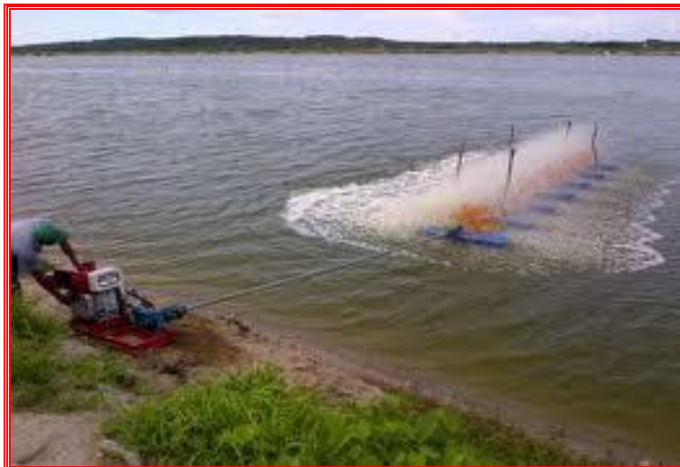
Fig.9. Aireadores de paleta en embalse dedicado al cultivo de tilapia, sistema semi intensivo.
